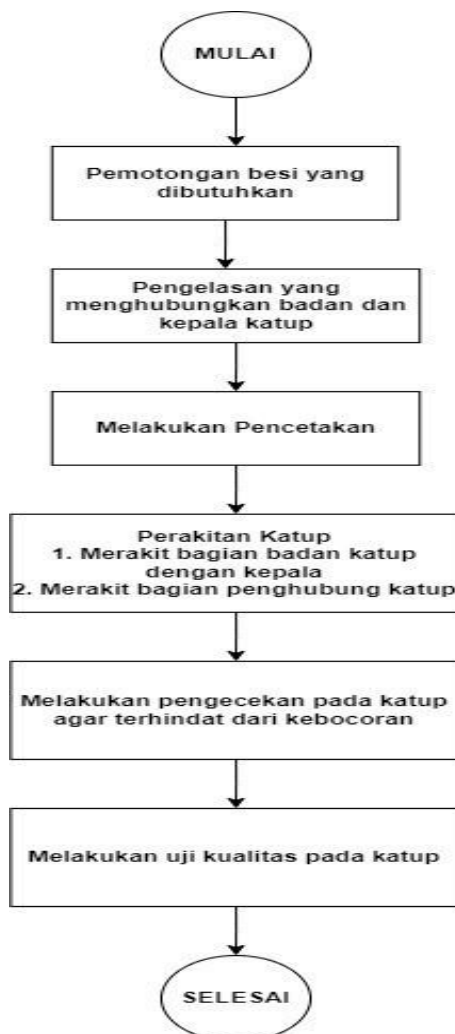
Gambar 2. 4 Alur produksi katup PT. AMM
