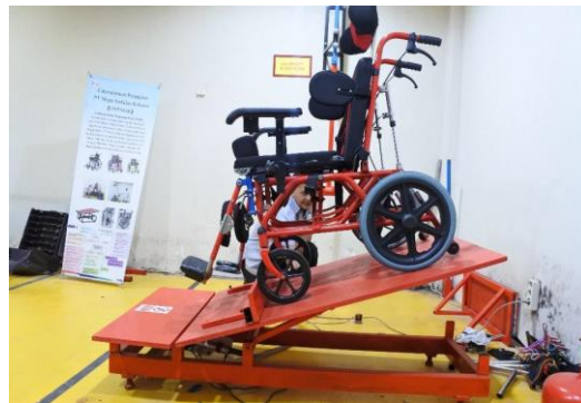
Gambar 3.15 Uji Kemiringan Prototipe Kursi Roda
