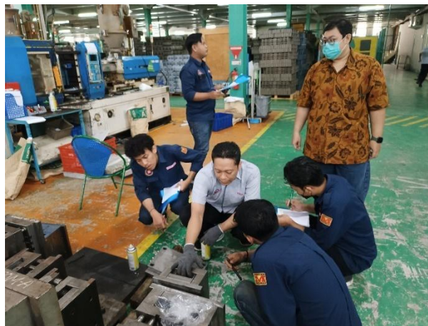
Gambar 3.8 Poses perawatan cetakan di lapangan
