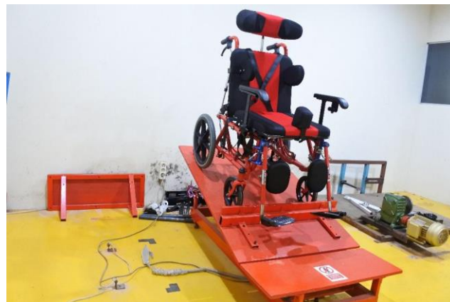
Gambar 3.16 Uji Kemiringan Prototipe Kursi Roda
