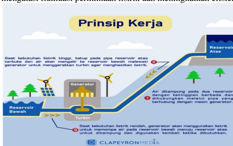
Gambar 3. Prinsip kerja PSH
