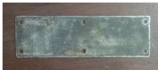
Gambar 6 Alas/Tutup Cetakan ASTM D3039
