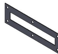
Gambar 2 Desain 3D Cetakan ASTM D3039
