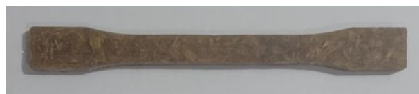
Gambar 15 Komposit Yang Sudah Dilepas Dari Cetakan
