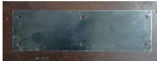
Gambar 11 Alas/Tutup Cetakan ASTM D638
