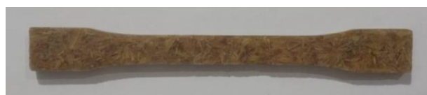
Gambar 16 Spesimen ASTM D638 Sebelum Uji Tarik
