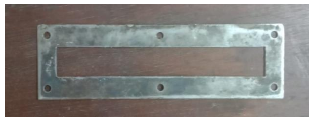
Gambar 5 Cetakan ASTM D3039
