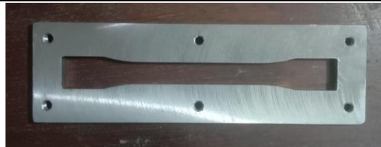
Gambar 10 Detail Ukuran Cetakan ASTM D638
