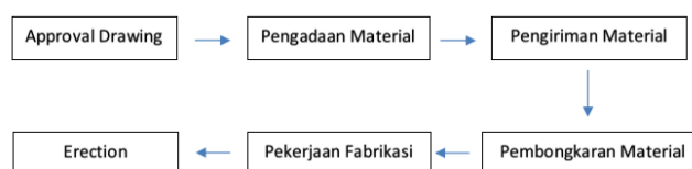
Gambar 5. Alur Pekerjaan Kontruksi baja CSB
