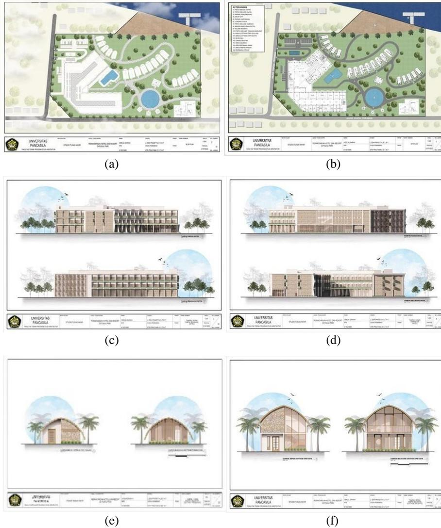
Gambar 4. (a) Blok Plan, (b) Site Plan, (c) Tampak Bangunan Hotel, (d) Tampak Bangunan Hotel, (e) Tampak Bangunan Resort Tipe Deluxe, (f) Tampak Bangunan Hotel Tipe Suite
