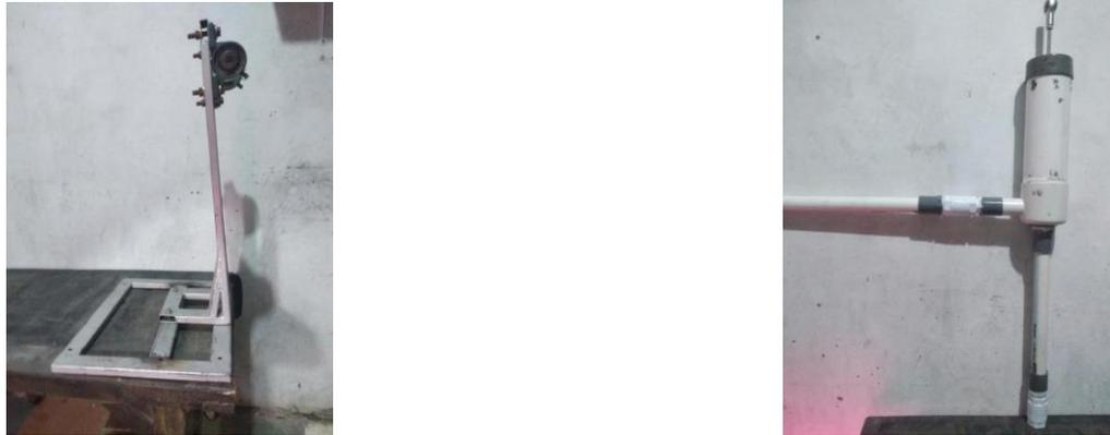
**Gambar 9.** Rangka pemegang pompa dan lengan ayun (a) serta Pompa piston dan sistem pemipaan (b)
