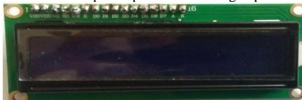
**Gambar 5.** LCD 16x2 I2C Tampak Depan.
