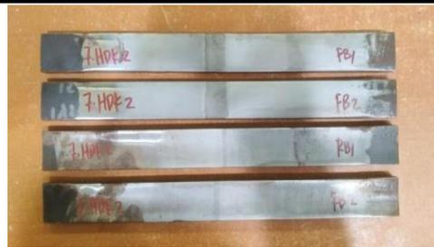
**Gambar 3.** Spesimen Bending Test
