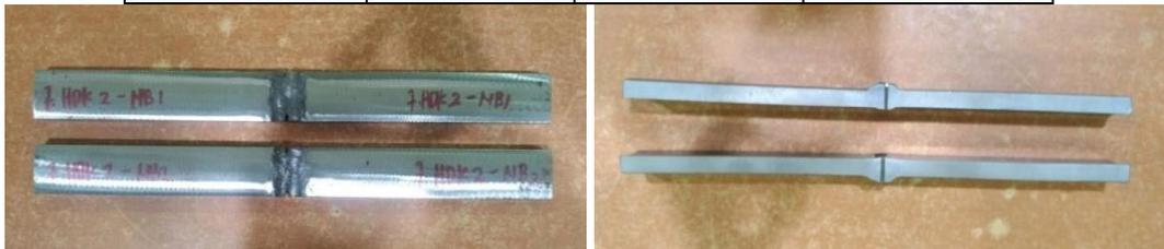
**Gambar 4.** Spesimen Nickbreak Test
