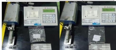
Gambar 12. Hasil pengujian kehalusan permukaan
