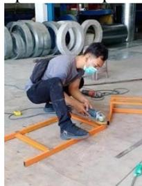
**Gambar 6.** Proses Pemotongan rangka.
