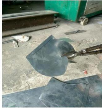
**Gambar 5.** Proses pemotongan impeller 2
