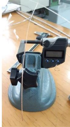
Gambar 1 Pengukuran Diameter
