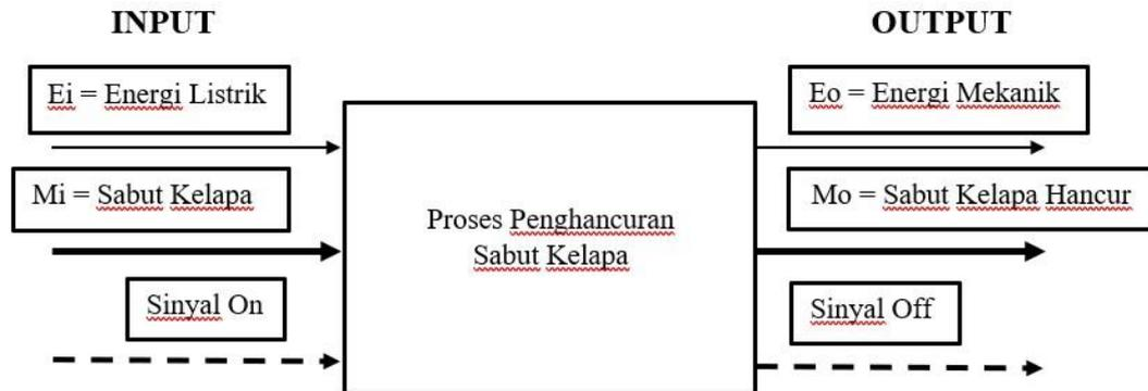
Gambar 2 Struktur Fungsi Keseluruhan
