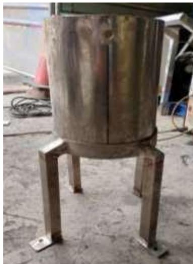
Gambar 5. *Assembly* rangka dengan dinding tangki
