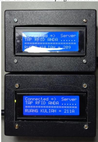
Gambar 8. Prototype alat absensi RFID berbasis IOT
