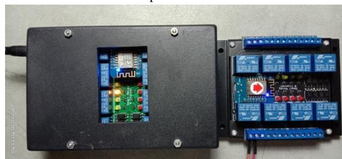
Gambar 10. Prototype alat kontrol kelistrikan
