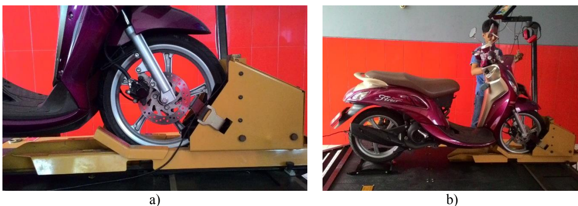
Gambar 2 : (a) Pengikatan sepeda motor pada chasis dynamometer ; (b) Pemasangan sensor
