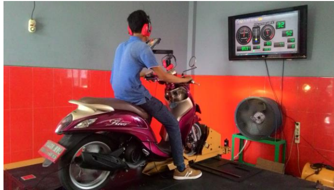
Gambar 3 : Pengujian sepeda motor pada chasis dynamometer
