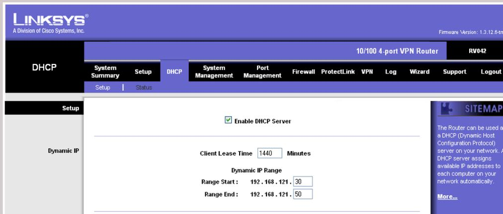
Gambar 7.35 Tampilan Setup Setingan Setelah Dilakukan Konfigurasi
