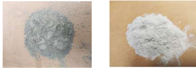
Gambar 2. Filler (a) semen dan (b) pasir silika
