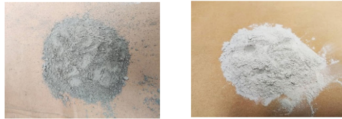
Gambar 2. Filler (a) semen dan (b) pasir silika
