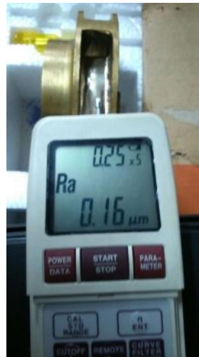
Gambar 5. 32 Pengukuran Kekasaran Permukaan Menggunakan Digital Surface Roughness Tester
