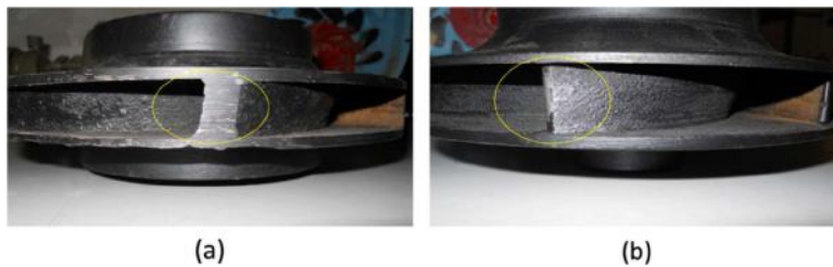
Gambar 2. 4 Sisi masuk impeller (a) sebelum pembulatan dan (b) sesudah pembulatan [18]
