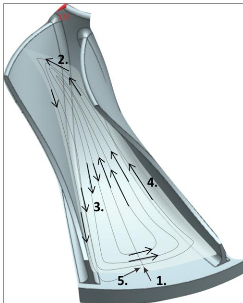
Gambar 4.37 Layer pertama pada proses roughing untuk impeller berdiameter 27 mm
