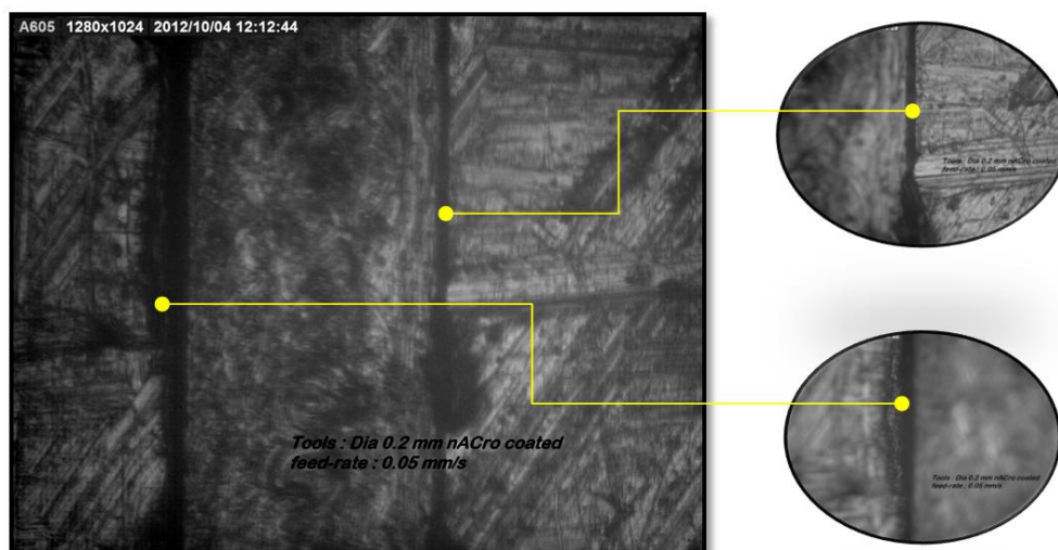
Gambar 4.95. Pembentukan burr dengan Tool nACro coated dengan Feed-rate 0.05 mm/s
