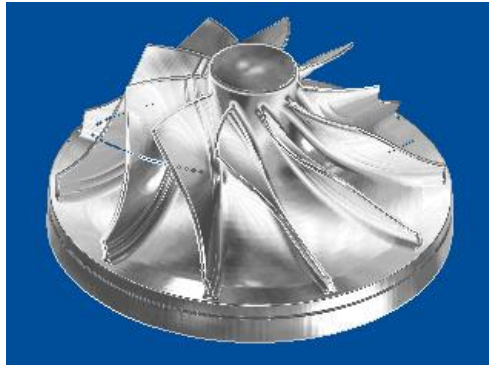
Gambar 4.53 Verikisai dan simulasi proses Hub finishing impeller berdiameter 27 mm menggunakan Powermill
