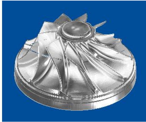
Gambar 4.48 Simulasi proses Blade finishing impeller berdiameter 27 mm menggunakan software Powermill
