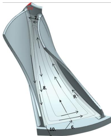
Gambar 4.38 Layer kedua dari strategi proses roughing impeller berdiameter 27 mm .
