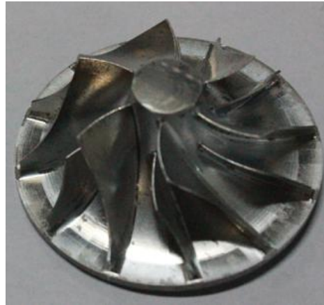
Gambar 4.30 Hasil proses pemesinan impeller dengan diameter 54 mm
