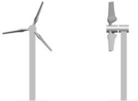
Gambar 11. Rancangan assembly turbin angin sumbu horizontal 3 (Tiga) dengan sudu tanpa di Twist
