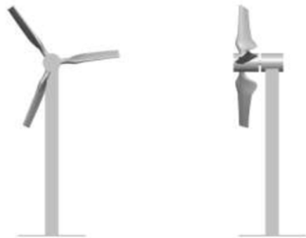
Gambar 12. Rancangan assembly turbin angin sumbu horizontal 3 (Tiga) dengan sudu di Twist
