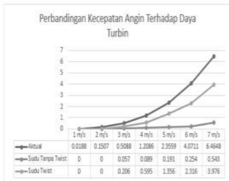
Gambar 13. Perbandingan kecepatan angin terhadap daya turbin teoritis terhadap model turbin angin
