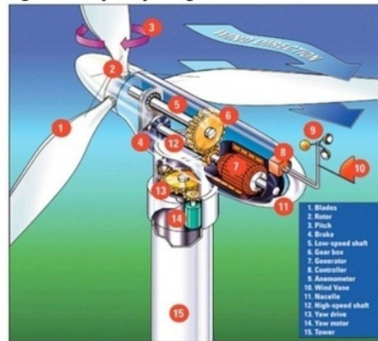
Gambar 2 Bagian-bagian dalam turbin angin sumbu horizontal [5]
