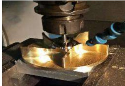
Gambar 2. 5 Proses pembuatan blade pada mesin Powermill CNC 3 Axis
