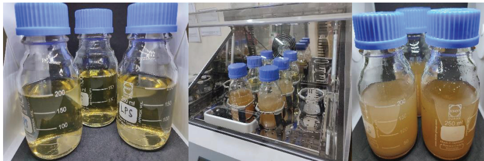
Gambar 3. Kultur bakteri yang telah disiapkan untuk pengujian Self-healing cracking
