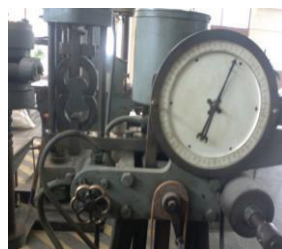
Gambar 2.3. Pengujian Kuat Tarik ( Tensile strength ) dan Kuat lekat ( Pullout strength )
