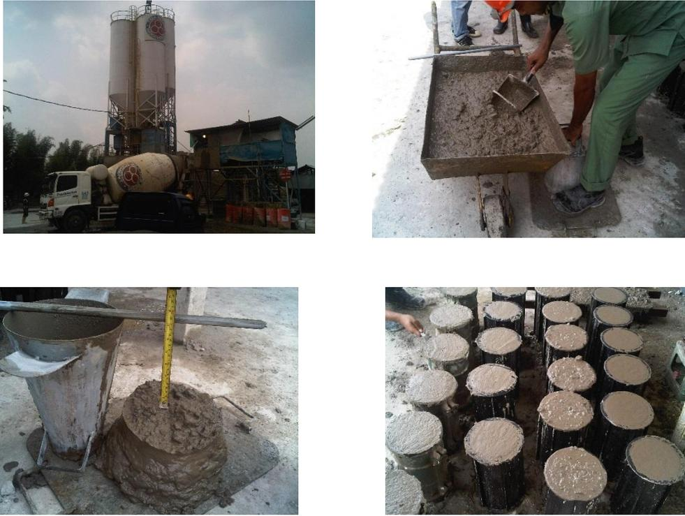
Gambar 2. Pembuatan benda uji untuk kuat tekan
