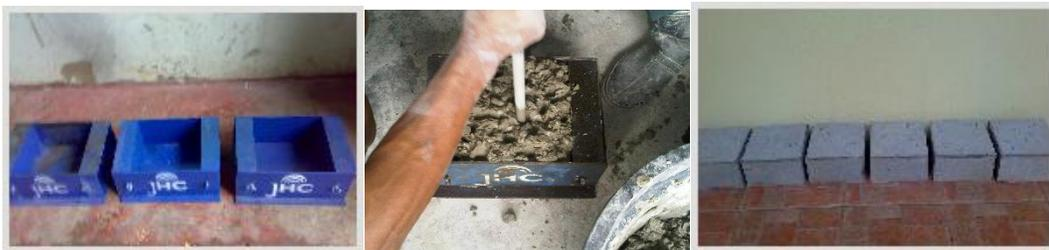
Gambar 3. Benda uji untuk permeabilitas
