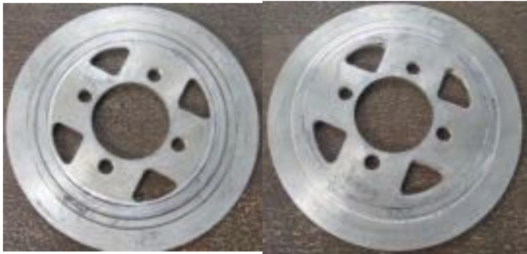
Gambar 4.3. Produk Komponen Disc Brake dari Komposit Hibrid Matriks Aluminium Berpenguat Partikel Keramik
