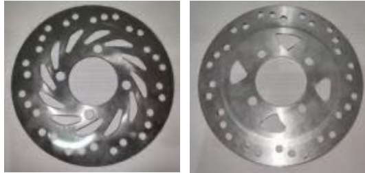
Gambar 1. Disc brake stainless steel (a) dan komposit hibrid (b)
