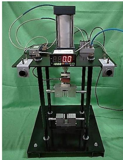
**Gambar 3** Mesin uji tarik [19]
