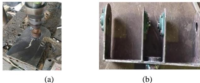
**Gambar 6.** rangka bagian tengah : (a) pelubangan (b) penyambungan dudukan solar tracking
