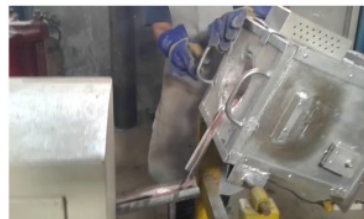
Gambar 8. Proses penuangan material coran.
