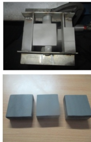
Gambar 10. Material benda kerja setelah dilepaskan dari jig penahan.
