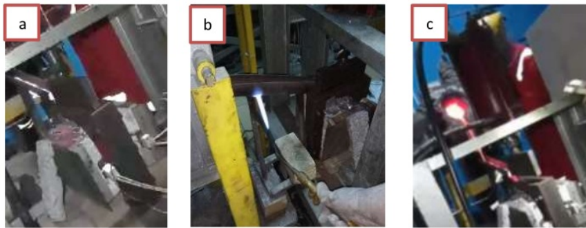
Gambar 6 : (a) Pemanasan saluran, (b) Proses penuangan kedalam cetakan, dan (c) Proses penekanan dengan hidrolik.
