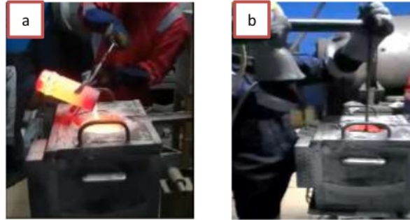
Gambar 5 : (a) Pencampuran unsur SiC dan Grafit, dan (b) Proses stirring .
