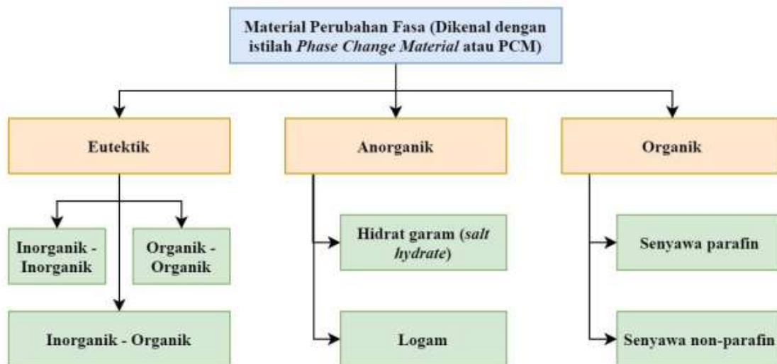
Gambar 7.8 Klasifikasi material panas laten [51]
