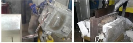
Gambar 4. Proses penuangan dan penekanan material coran
