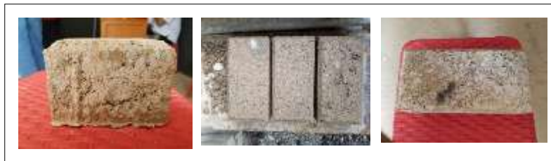
Gambar 5. Produk paving geopolimer yang dihasilkan
