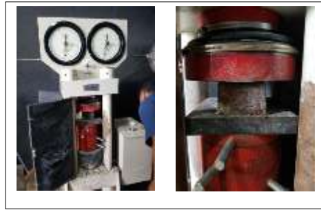
Gambar 3. Pengujian kuat tekan paving geopolimer
